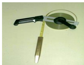
Figure 1.3 : Pige à ruban d'acier et lest laiton, équipée d'une mise à la terre (Appareil destiné à jauger les réservoirs, en particulier pour l'industrie pétrolière).
