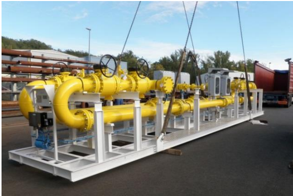
Figure 1.1 : Skid de comptage de gaz naturel.
